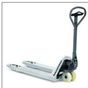
AM G20 - superficie galvanizzata per la protezione contro la corrosione
